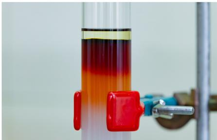
Imagem 1. Exemplo de separação por cromatografia.
